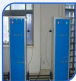
公司自研多功能自动消毒加药设备，可适应化学法二氧化氯、单过硫酸氢钾复合盐、固体二氧化氯AB剂、二氯异氰尿酸钠及液体次氯酸钠等常用水处理消毒药剂的制备及自动加药功能，具有广泛适应性。
