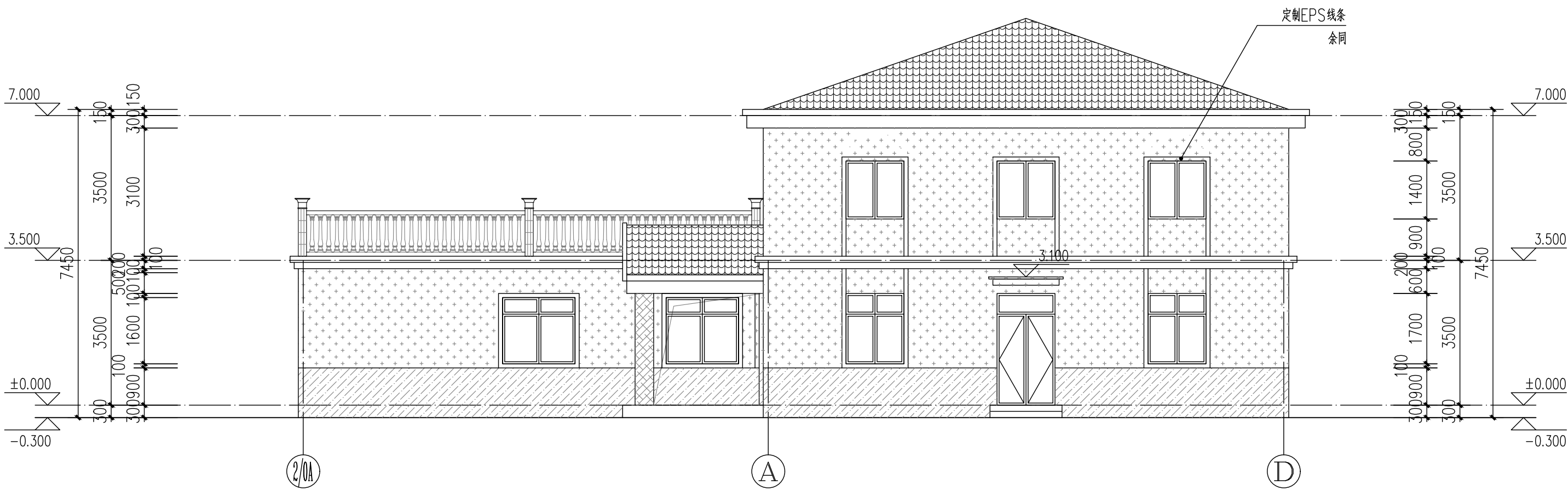
主体建筑A-D轴立面图 1:100
