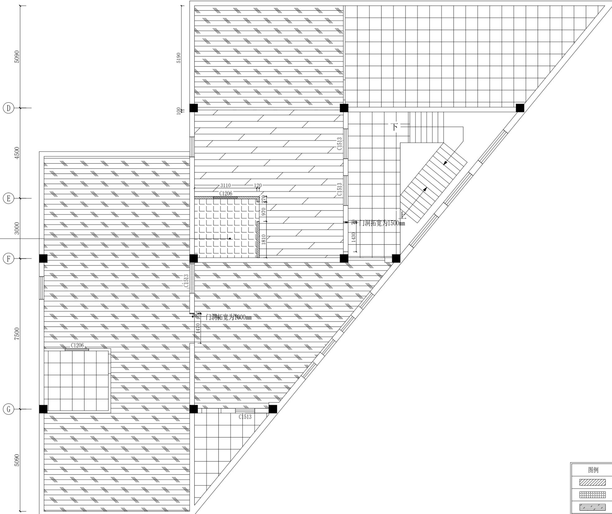
地砖拆除到原地面，墙砖、吊顶拆除
