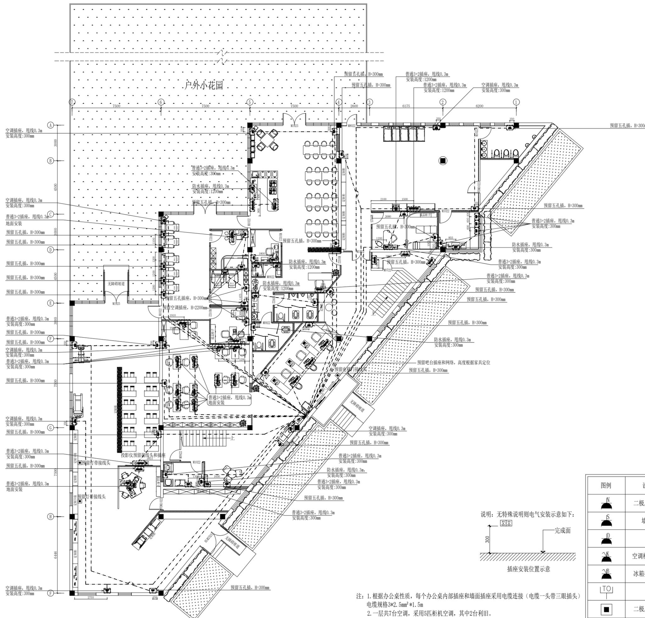
注: 1. 根据办公桌性质, 每个办公桌内部插座和墙面插座采用电缆连接(电缆一头带三眼插头) 电缆规格3\*2.5mm<sup>2</sup>\*1.5m
